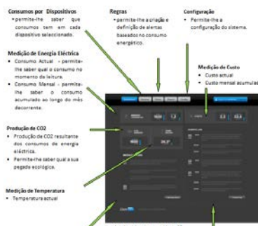
Figura 5 – Sistema de monitorização dos consumos energéticos (Fonte: Domótica)
